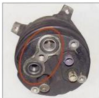
Anschlussöffnungen wurden nicht verschlossen.
