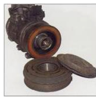
Aggregat ist zerlegt oder aus Altteilen zusammengebaut.
