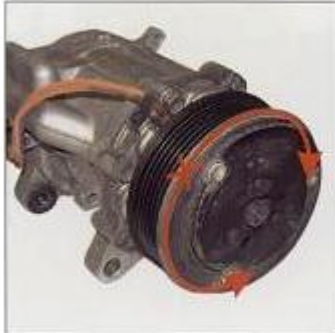
Kompressorwelle ist nicht drehbar
