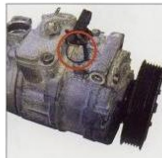
Kabelsatz und elektrische Anschlüsse sind nicht intakt.
