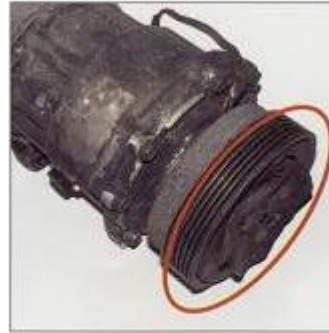
Kupplungsgruppe ist beschädigt.
