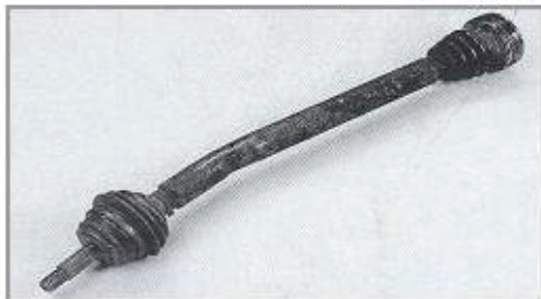
Die Welle ist in allen Teilen komplett, aber das Rohr (die Profilwelle) ist verbogen.
