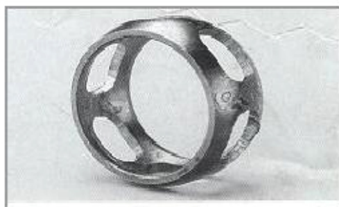
Verschleißspuren (Kaltverschweißungen) an Innen- und Außenkonturen bei radseitigen Festgelenken.
