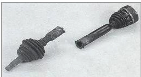
An der Welle ist das Rohr (die Profilwelle) gebrochen.
