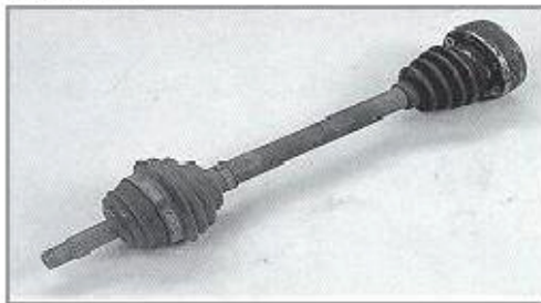
Die Welle ist in allen Teilen komplett, jedoch so stark verrostet, daß keine Aufarbeitung möglich ist.
