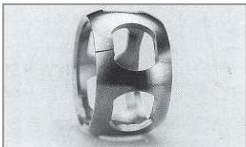
Bruch in einem oder mehreren Fenstern.
