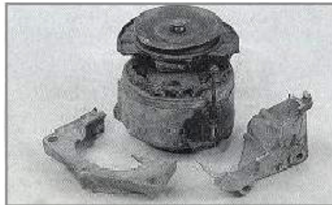
Die Lichtmaschine weist Ausbrüche am Gehäuse auf.
