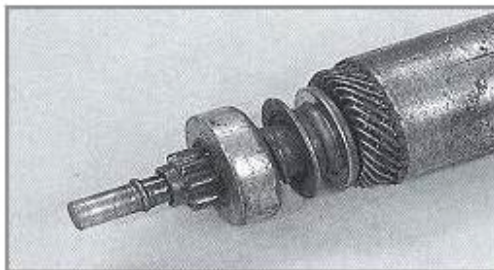
Der Anlasser weist eine blau angelaufene Achse auf. (Der Anlasser ist mitgelaufen.)
